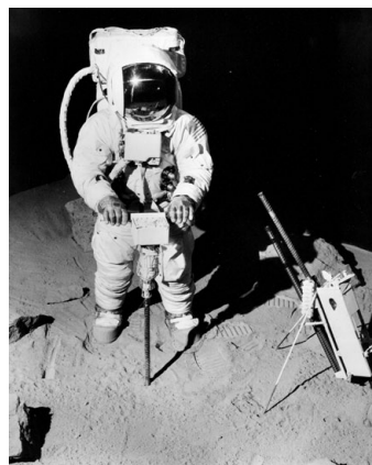
1971年のアポロ計画で使われた、 月面掘削用のコードレスドリル
